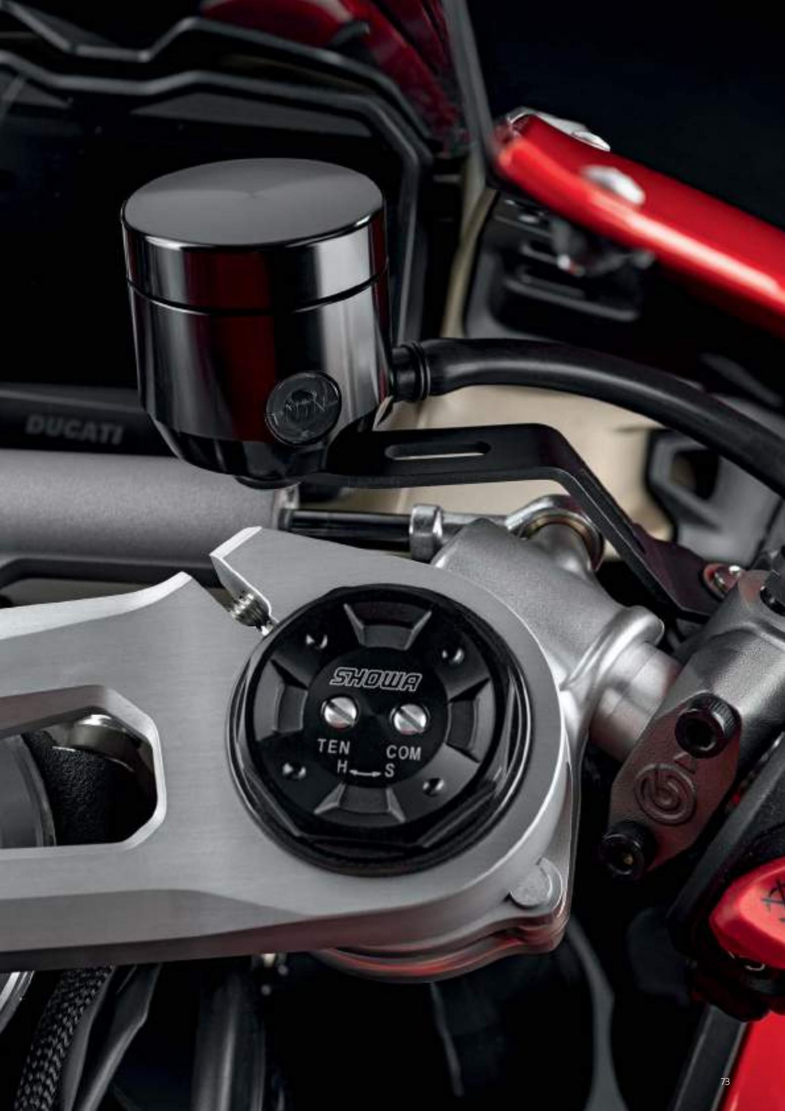
Serbatoio liquido frizione. L'inconfondibile design Ducati si unisce all'esperienza di Rizoma per dare vita a un prezioso accessorio tutto made in Italy. Realizzato in alluminio dal pieno, mantiene l'aspetto originale nel tempo grazie all'anodizzazione di alta qualità e alla lavorazione di CNC. Un dettaglio che rappresenta il connubio perfetto tra funzionalità ed estetica, accentuando ancora di più lo spiccatissimo look racing della moto.
