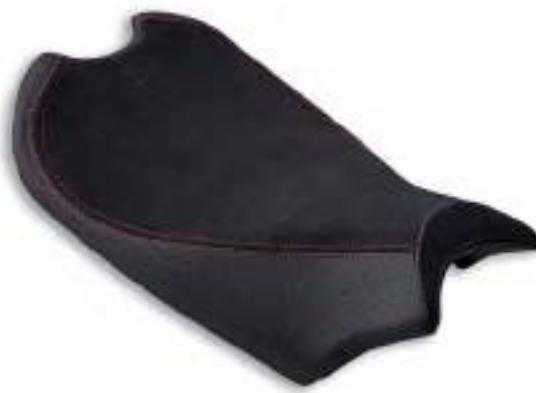
Assento alto para piloto. Acessório estudado para aproveitar ao máximo todas as curvas pilotando a Panigale V4. A altura do assento, aumentada de 20 mm em relação à versão de série, juntamente à construção com espumas mais compactas, ao acolchoamento mais espesso e ao revestimento em tecido técnico, oferece a máxima sustentação e minimiza a fadiga do piloto, melhorando consideravelmente o conforto durante a pilotagem.
