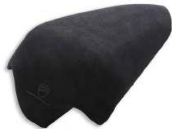
驾驶员高鞍座。鞍座的高度相对于标准版升高了 20 毫米，再结合更致密的泡沫材质，更厚的填充物以及科技面料外罩，为车手提供了最大的支撑，最大程度上减轻车手的疲劳感，有效改善驾驶舒适度。
