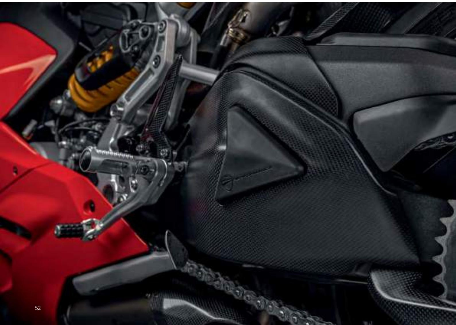
Protezione in carbonio per carter alternatore. La leggerezza e la resistenza della fibra di carbonio e fibre aramidiche si uniscono a un design accattivante e un finishing tipicamente racing in un accessorio che offre la massima protezione in caso di scivolata ed esalta l'animismo sportivo ed elegante della Panigale.
