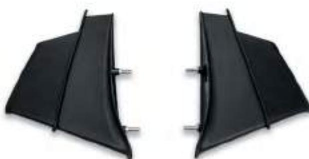
Staffe per carene con ali. Kit necessario per il montaggio delle carene della V4R sulla V4 e V4S MY 18 e 19. Realizzate in materiale di alta qualità, garantiscono stabilità e resistenza. L'accessorio indispensabile per rinnovare il look della propria V4.
