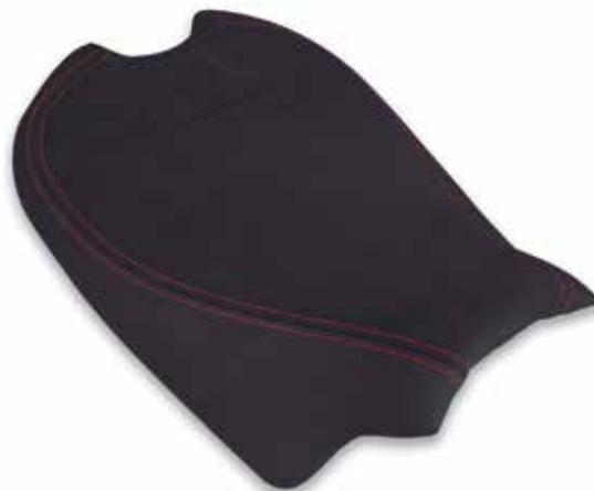
Sella alta pilota. L'altezza della seduta, maggiorata 20 mm rispetto alla versione di serie, unita alla realizzazione in schiumati più compatti, all'imbottitura più spessa e al rivestimento in tessuto tecnico, offre il massimo sostegno e minimizza l'affaticamento del pilota, migliorando sensibilmente il comfort di guida.
