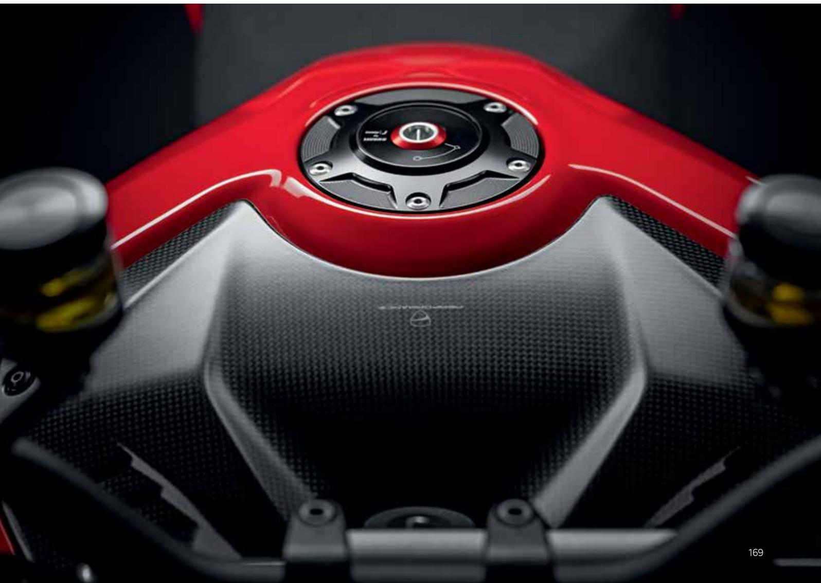
Cover strumentazione in carbonio. Sostituisce la cover cruscotto di serie con materiali hi-tech e l'aggiunta di protezione aerodinamica.
