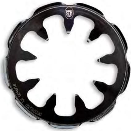
Cover frizione a secco. Studiata per offrire un'ottimale ventilazione della frizione a secco nell'utilizzo in pista, è realizzata in alluminio dal pieno, finemente lavorato di CNC, e anodizzato nero per garantire un'elevata resistenza e mantenere l'aspetto originale nel tempo. Il design lineare ma deciso esalta la preziosa estetica della moto, donandole un autentico stile racing ed esaltando il tipico sound sportivo della frizione a secco.
