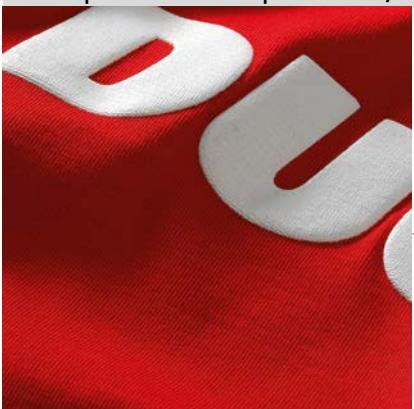
La stampa si esegue con un inchiostro a base PVC attraverso un processo di fusione nel forno con il tessuto. Questa stampa permette di ottenere una superficie plastica morbida con effetto lucido. I tessuti così trattati sono lievemente più rigidi.
