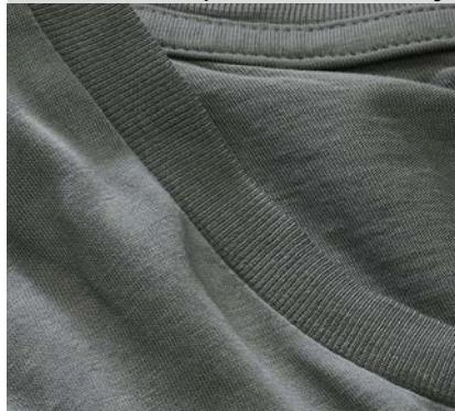
La tintura in capo viene applicata al capo finito e consente di ottenere un effetto disomogeneo in prossimità delle cuciture.
