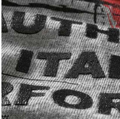
Questa tecnica presenta una caratteristica speciale ad effetto rilievo con profili netti e non bombati come per la tecnica rigonfiante, con spessori e colori vari.
