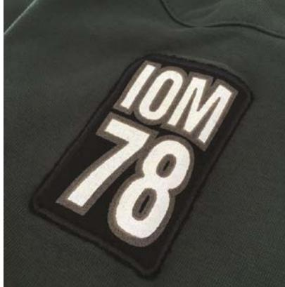
È un disegno eseguito con una macchina da ricamo su un pezzo di tessuto e poi ritagliato. Il termine patch ricamato è di origine inglese e viene di norma associato alle divise militari. Il bordo ricamato si esegue con una particolare macchina da cucire che si chiama overlock per dare una migliore finitura aggiuntiva e ottenere un ricamo di alta qualità.
