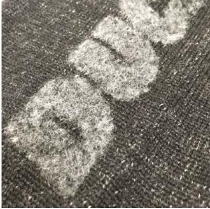
L'agugliatura è il processo con cui si ottiene un tessuto non tessuto dotato di una certa consistenza dovuta alla penetrazione di una parte delle fibre trascinate verticalmente dal moto degli aghi. Successivamente per aumentare la resistenza del prodotto possono essere eseguite lavorazioni di finissaggio quali resinatura o termofissaggio. È il procedimento meccanico con cui si ottiene il feltro nell'industria tessile.
