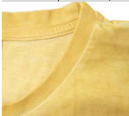
Si tratta di tinture in capo che presentano un aspetto peculiare costituito da una tintura superficiale irregolare che pone in evidenza gli spessori diversi del capo e le sue ondulazioni. Il particolare processo di tintura è differente per ogni capo rendendolo unico. Tale procedimento realizzativo comporta costi piuttosto elevati a causa dell'alta percentuale di scarto.
