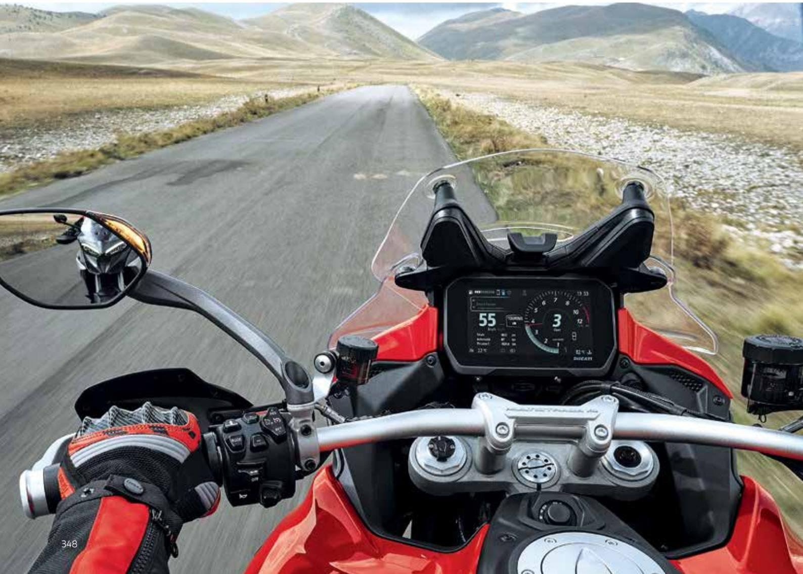
**Vehicle Hold Control.** Consente partenze in salita più agevoli anche con passeggero e moto a pieno carico. Tirando in maniera decisa la leva del freno, il sistema mantiene il veicolo fermo attivando il freno posteriore per diversi secondi, fino a una nuova accelerazione o ulteriore frenata. Facile da utilizzare, garantisce un controllo ottimale della moto e la massima sicurezza.
