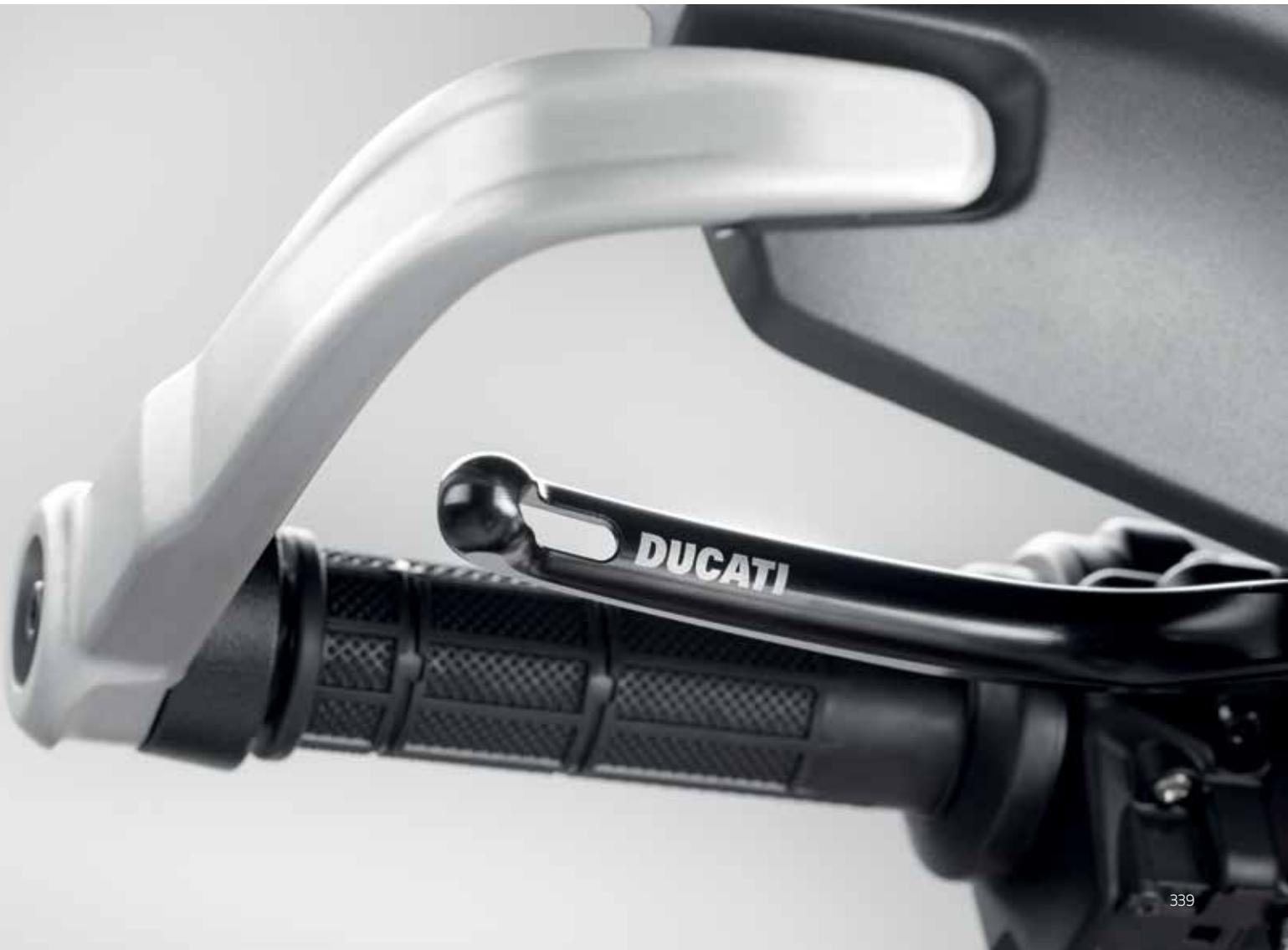
Leva frizione. Realizzata con lavorazione 3D e caratterizzata da una linea tipicamente sportiva. Regolabile e snodata, per ridurre la possibilità di rottura. La leggerezza ed aerodinamicità, unite ad un elevato grip, forniscono un alto livello di performance. Sviluppata in collaborazione con Rizoma.
