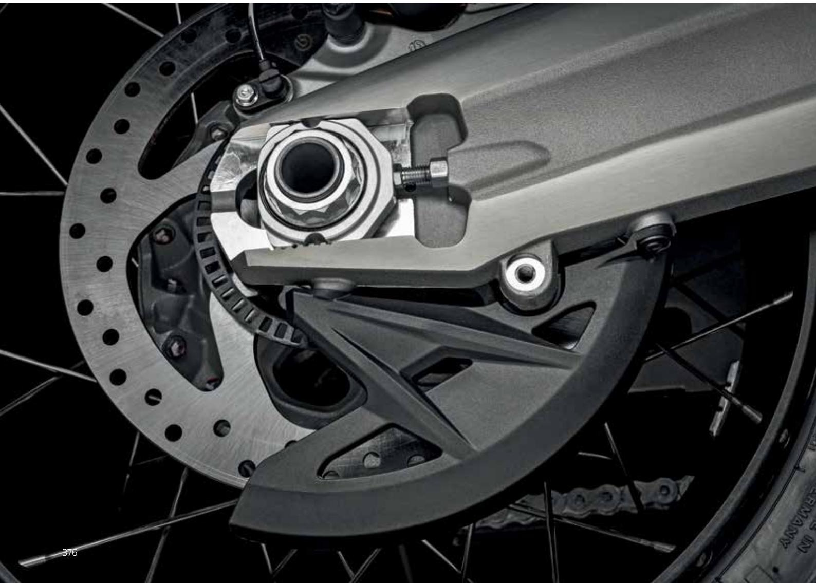
Protezione catena inferiore. Accessorio realizzato in materiale plastico dalle ottime performance meccaniche, per proteggere al meglio gli organi di trasmissione dai detriti e il pilota in caso di caduta. Design lineare ma deciso, per non rinunciare allo stile neanche nei dettagli.
