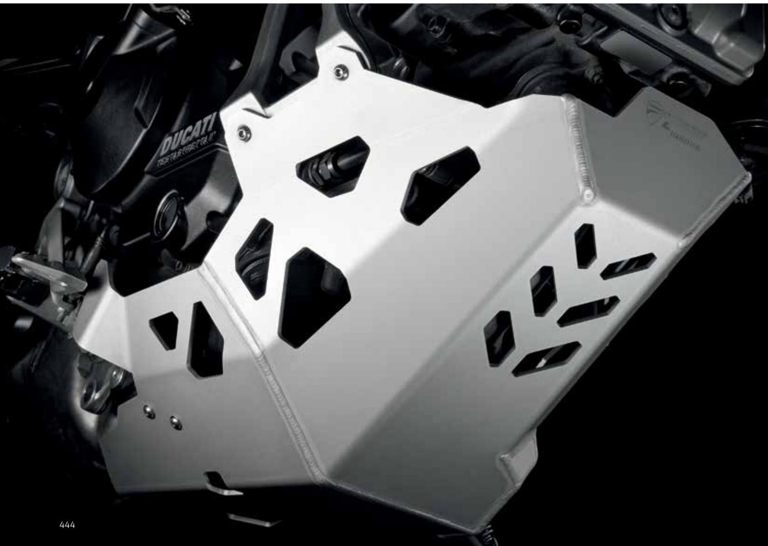
Piastra paramotore. Studiata per proteggere il motore da detriti e possibili urti. Mantiene l'aspetto originale nel tempo grazie all'anodizzazione di alta qualità.
