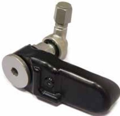
Tappo serbatoio Hands-free. Il rifornimento carburante diventa veloce e possibile anche senza chiave, grazie al sistema ad apertura elettrica che si sblocca automaticamente allo spegnimento della moto e si blocca nuovamente dopo 60 secondi in caso di mancato rifornimento.
