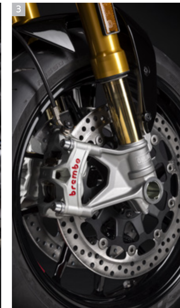
3 Promieniowo montowane 4-tłoczkowe zaciski Brembo Stylema Monoblock
