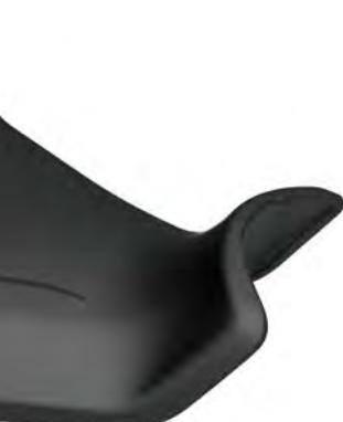
Sella alta. Maggiorata in altezza di 20 mm, è realizzata con schiumati ad alta densità e rivestita con tessuti tecnici. Un accessorio studiato per ottimizzare l'ergonomia qualsiasi sia la altezza del pilota e sposarsi perfettamente con il look della moto.
