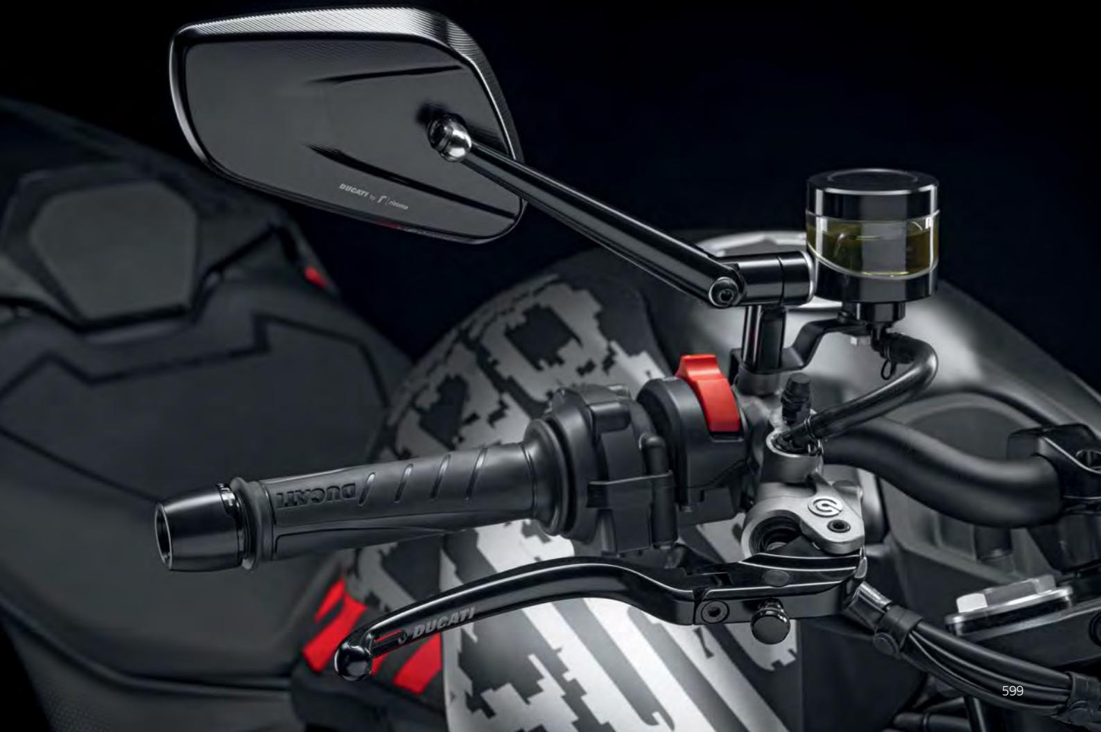
Leva frizione. Realizzata con lavorazione 3D e caratterizzata da una linea tipicamente sportiva. Regolabile e snodata, per ridurre la possibilità di rottura. La leggerezza ed aerodinamicità, unite ad un elevato grip, forniscono un alto livello di performance. Sviluppata in collaborazione con Rizoma.
